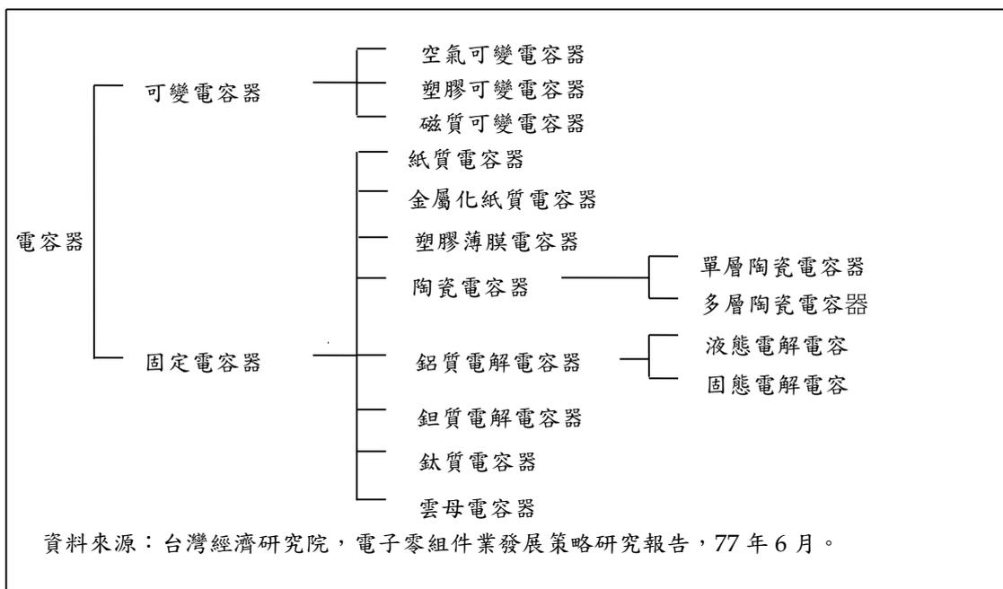
各種電容器因介質導電性及物理性之不同因而產生不同之電氣特性，其功能及應用範圍亦各異，例如行動電話或筆記型電腦多使用體積小的陶瓷電容器，電視機與監視器則要求大容量電容器，而航太及軍事用途則多使用壽命長或頻率性高之電容器，此外同一種產品可同時使用不同特性之電容器，藉由相互搭配以完成電子迴路運作功能。
